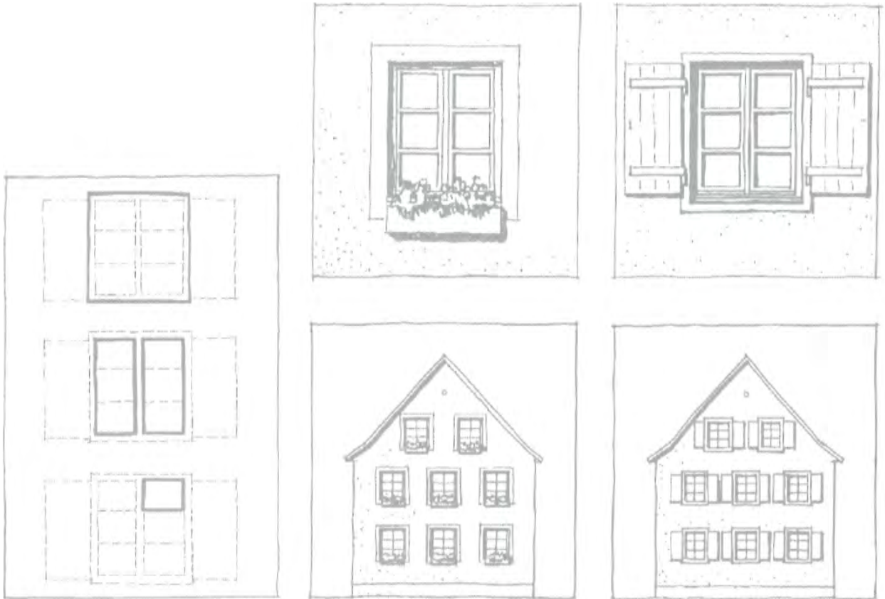
Sprossenfenster mit abgesetzten Putzfeldern (Putzfasche)
