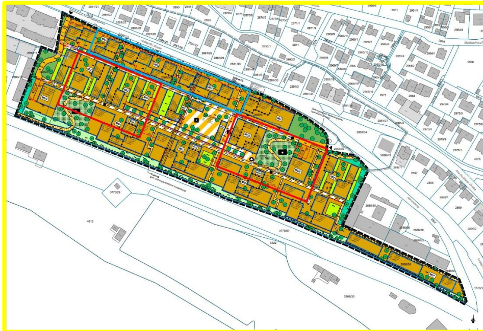
Abb. 27: Übersichtsplan zur Lage der drei Umspannstationen (blau und rot markiert) (Stadtwerk am See)
