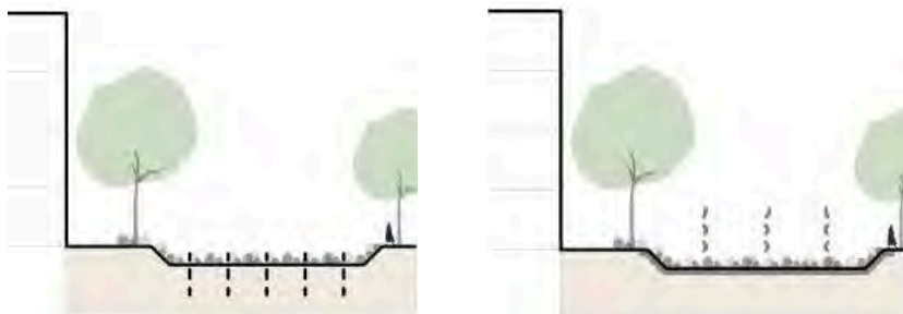
Abbildung 10: Sicker- und Retentionsmulden (studio boden)
