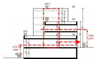
LANGHAUS 3G/5G < 8m = Rettung über tragbare Leiter > 8m = Rettung über Hubrettungsfahrzeug
