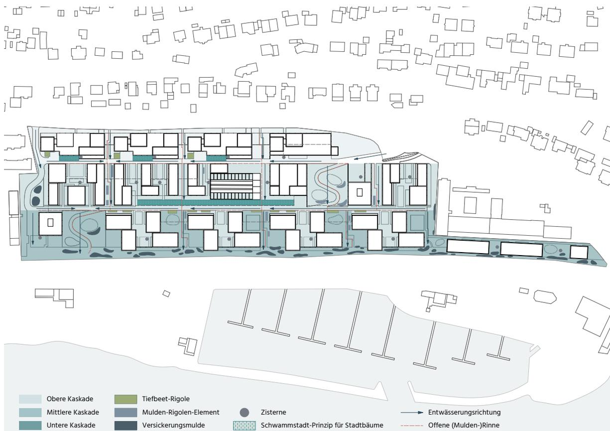
Abbildung 3: Regenwassermanagementkonzept mit einzelnen Elementen auf dem Gesamtareal (studio boden)
