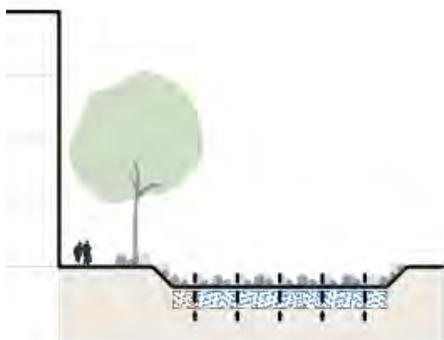
Abbildung 11: Mulden-Rigolen-Element
