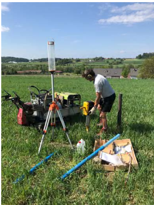
Techniker beim Sickerversuch im Bohrloch.
