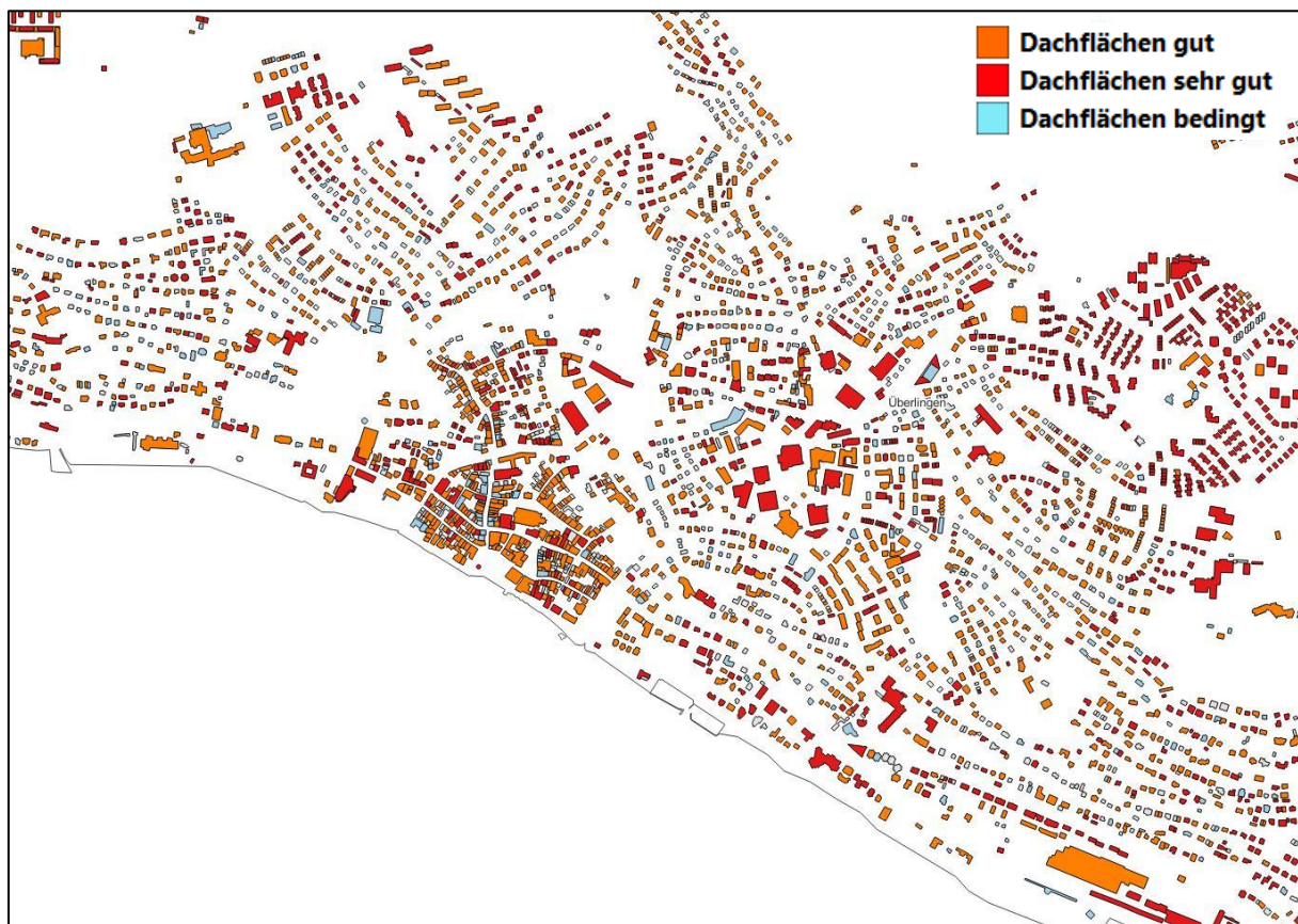
Abbildung 24: Potenzialkarte „Photovoltaik – dezentral“ auf Gebäudeebene (Einstufung nach Energieatlas BW)
