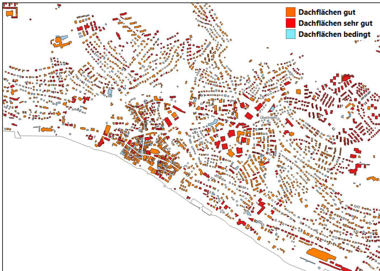
Abbildung 23: Potenzialkarte „Photovoltaik – dezentral“ auf Gebäudeebene (Einstufung nach Energieatlas BW)
