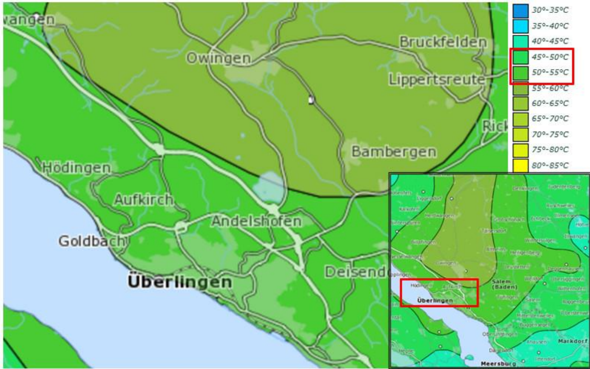
Abbildung 20: Potenzialkarte „Tiefengeothermie“ in 1.000 m
