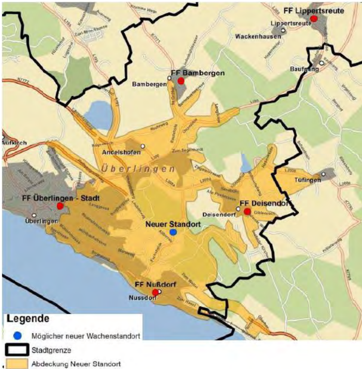
Abbildung 2. 5 Minuten Fahrzeit Isochrone bei Anfahrt mit Signal aus dem Feuerwehrhaus eines optimalen Standortes im östlichen Stadtgebiet von Überlingen, o.M.
