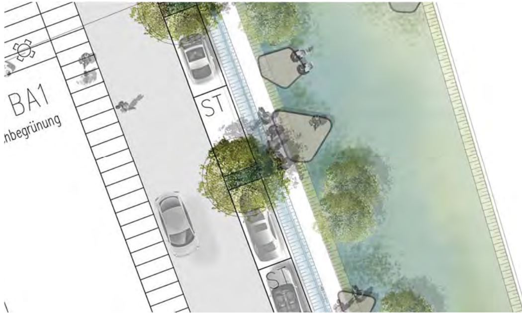
Abbildung 9 Draufsicht auf die Versickerungsmulde 1 bei Vollstau
