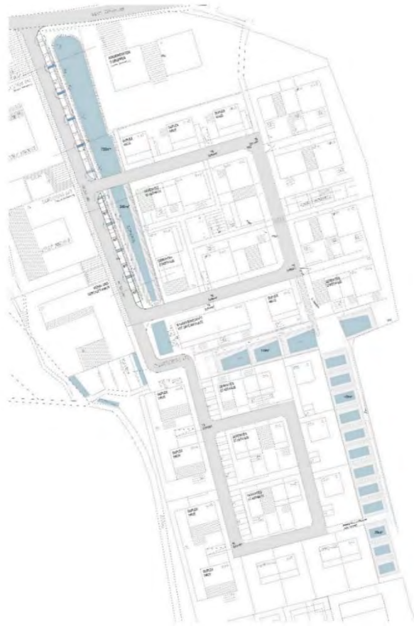
Abbildung 6 Projektgebiet mit Versickerungsmulden (blau), Kaskaden-Mulden-System
