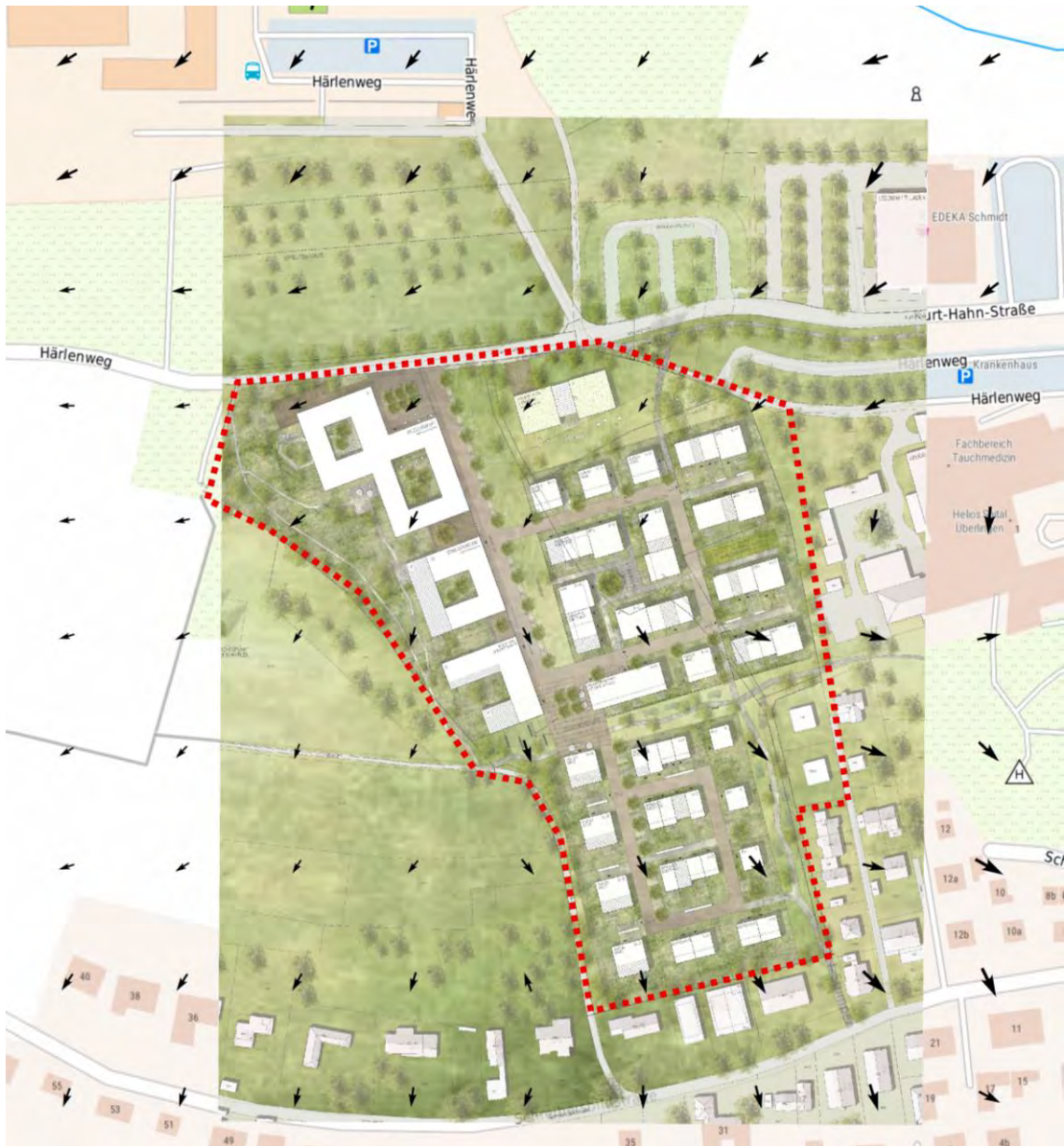
Abbildung 6: Überlagerung des Kaltluftabflusses im Bestand (Vektoren) und der Neuplanung (Städtebaulicher Entwurf), ohne Maßstab.
