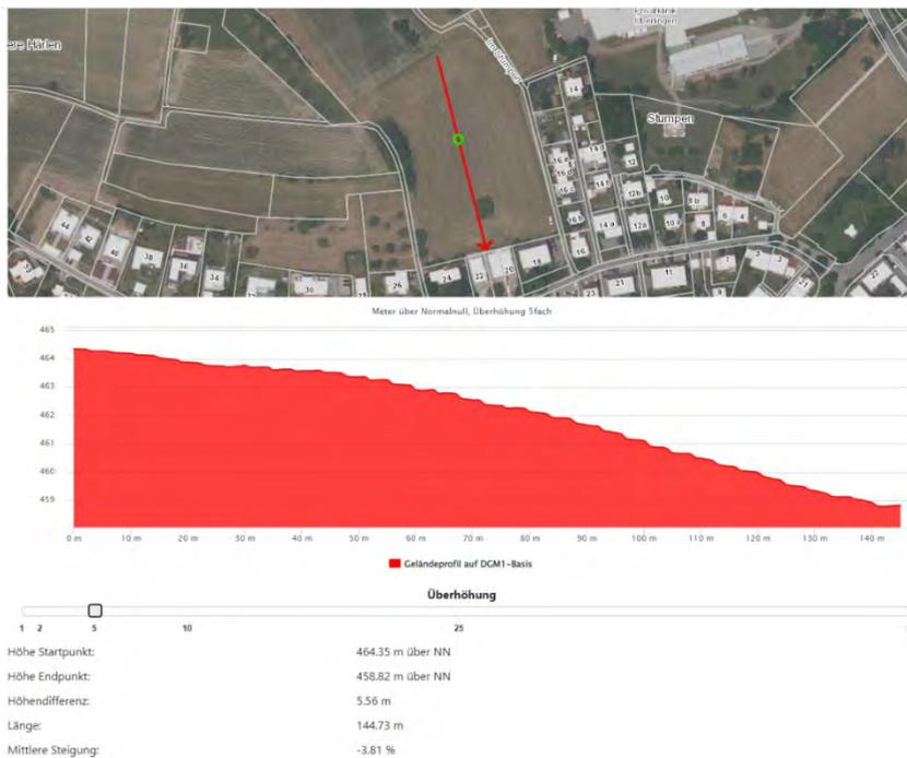
Abbildung 3 Längsschnitt im unteren Teil des Projektgebietes (Gefälle: -3,81% in Nord-Süd-Richtung). 5-fache Überhöhung
