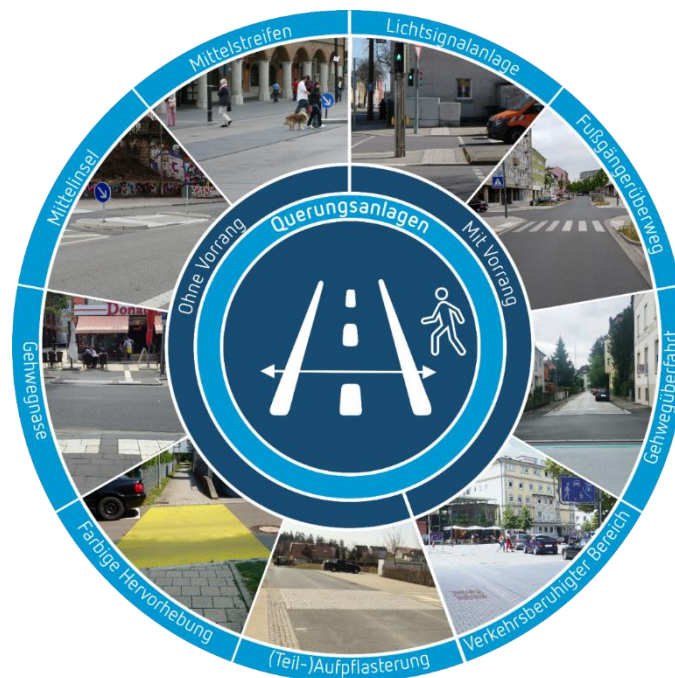
Abbildung 9: Unterschiedliche Querungsanlagen für Fußgänger
