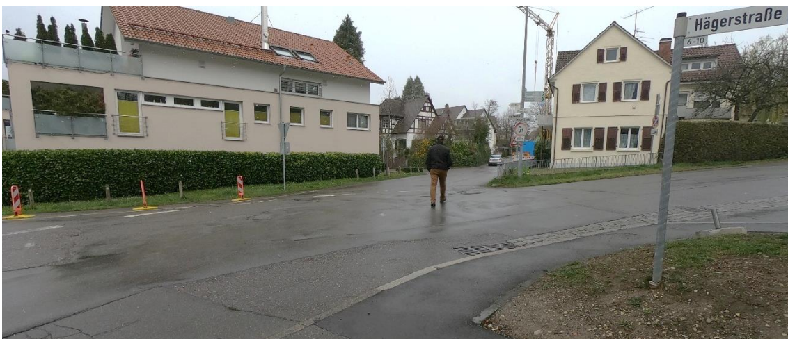
Abbildung 61: große Querungsdistanzen und schlechte Einsehbarkeit, fehlende/schmale Gehwege
