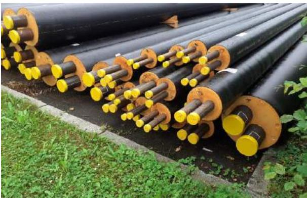
Abbildung 121: NW-Leitung (verschiedene Dimensionen) in KMR-Doppelrohrbauweise (eigene Darstellung)
