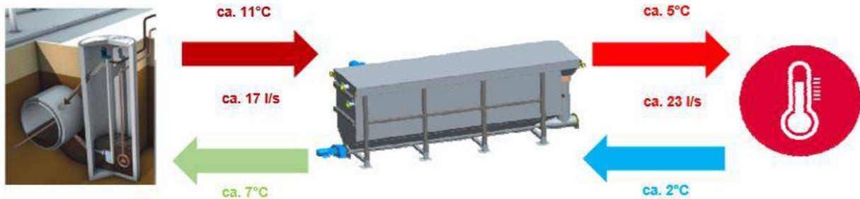
**Abbildung 59: Volumenströme und Temperaturen AW-WÜT, 17 l/s AW-Trockenwetterabfluss (abgeändert nach HUBER SE, 2020)**
