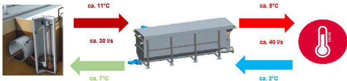
**Abbildung 60: Volumenströme und Temperaturen AW-WÜT, 30 l/s AW-Trockenwetterabfluss (abgeändert nach HUBER SE, 2020)**
