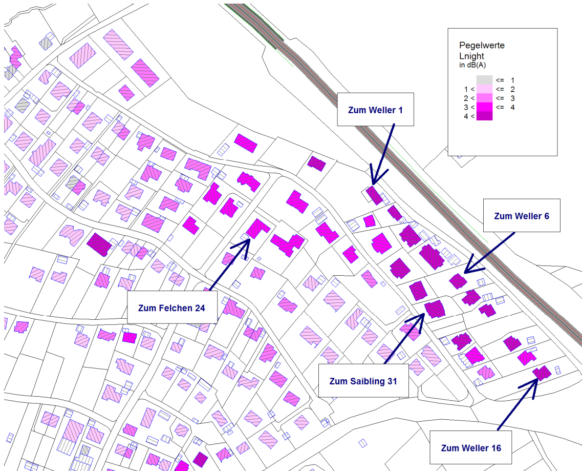
Abbildung 14: Differenzkarte ohne/mit offenporigem lärmarmem Belag auf der B 31 in Nussdorf , höchste Pegelreduzierung am Gebäude (freier Maßstab)
