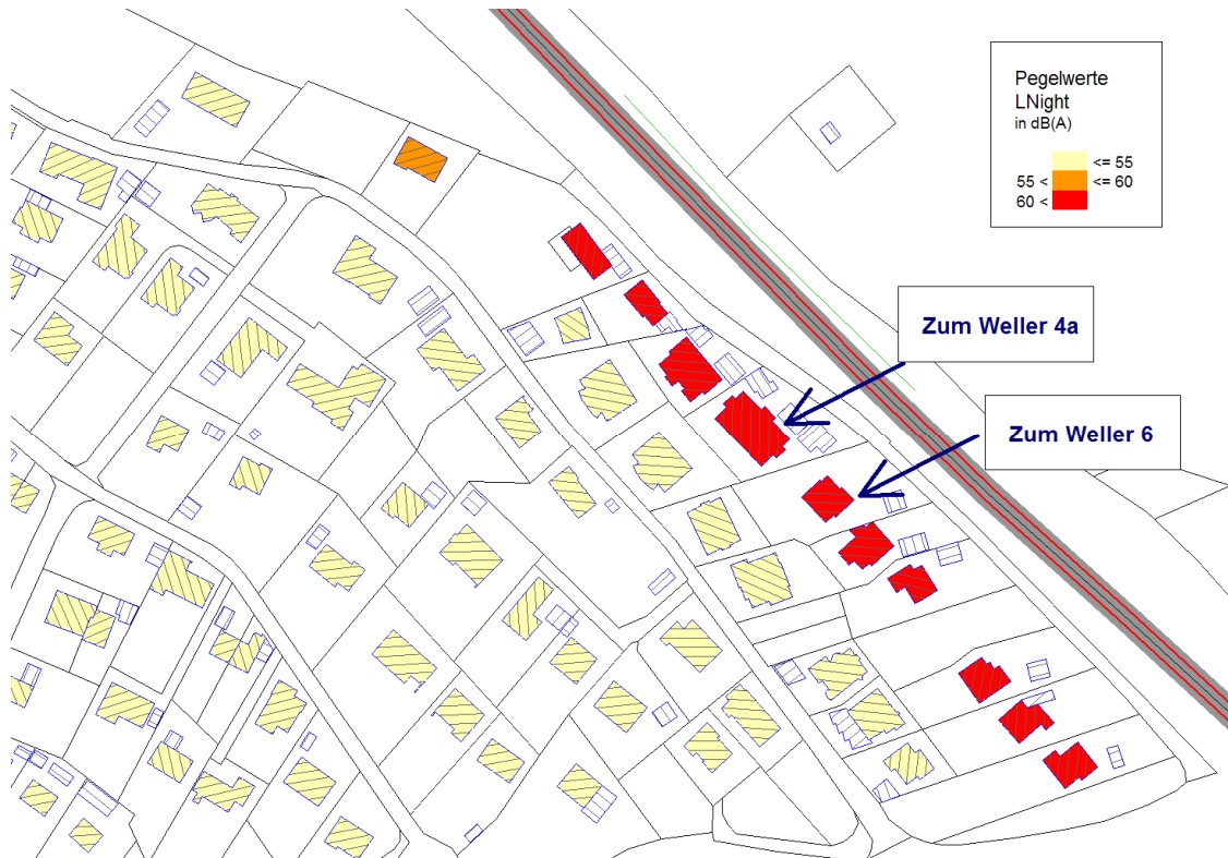
Abbildung 9: Lärmschwerpunkt B 31 im Bereich Nussdorf (freier Maßstab)
