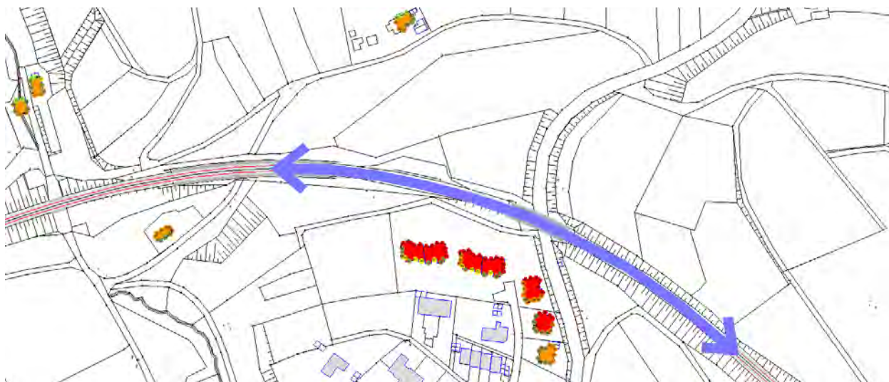
Abbildung 19: Geschwindigkeitsbeschränkung 70 km/h bei B 31-alt-1 Guggenbühl auf 350 m
