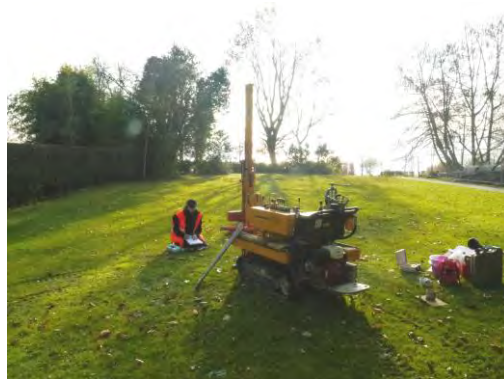
Abb.6: Schwere Rammsondierung am Ansatzpunkt DPH 2/13
