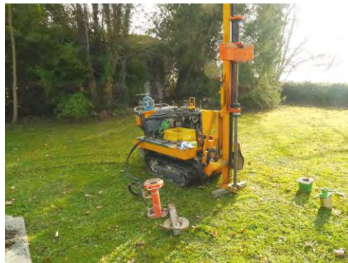
Abb.4: Rammkernsondierung am Ansatzpunkt RKS 2/13
