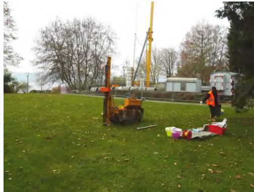
Abb.3: Rammkernsondierung am Ansatzpunkt RKS 1/13
