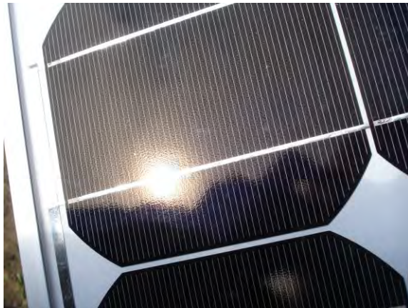
Bild 3: Strukturierte Oberfläche eines PV-Moduls mit Sonnenreflex (Foto: H. Meseberg)
