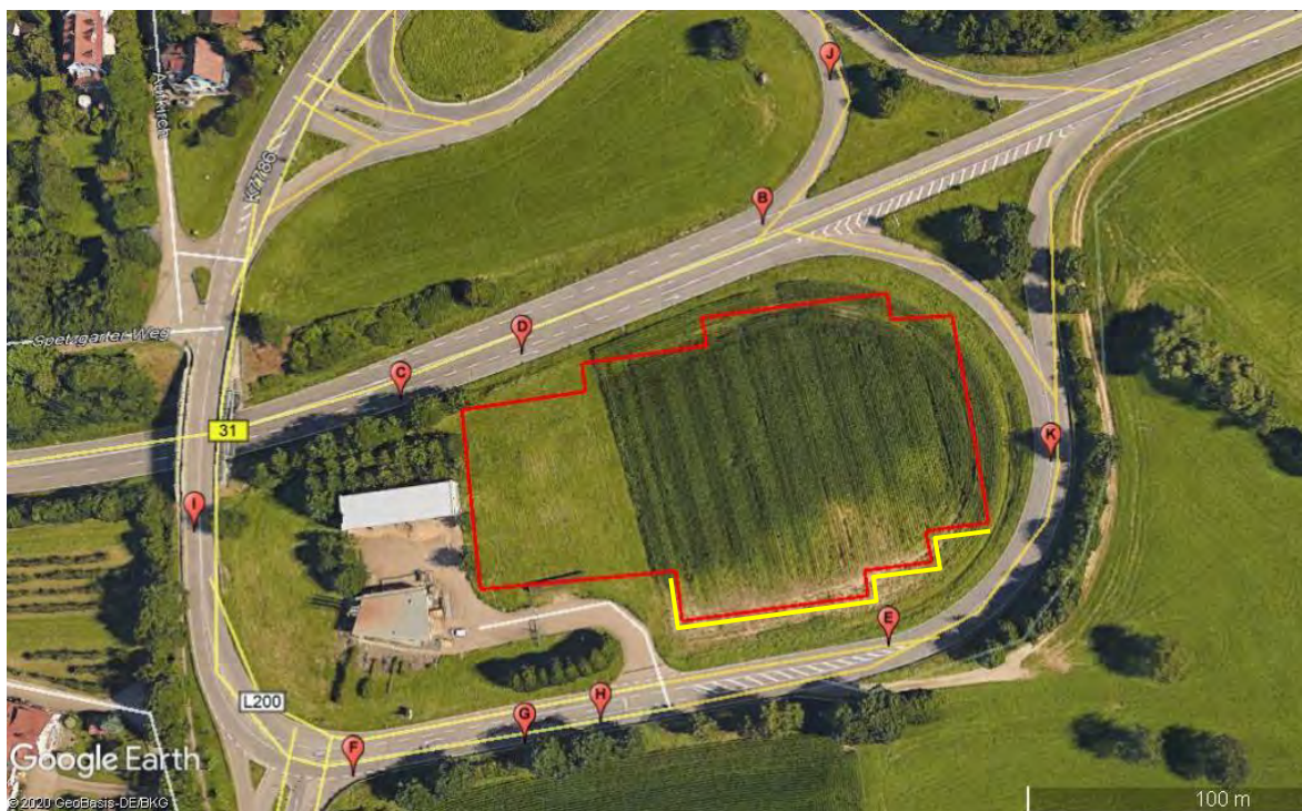
Bild 1: Schematische Darstellung der geplanten Solarthermieanlage Überlingen (rot umrandet). Gelbe Linie: Zaunabschnitt, der mit einem Kunststoffgewebe auszurüsten ist
