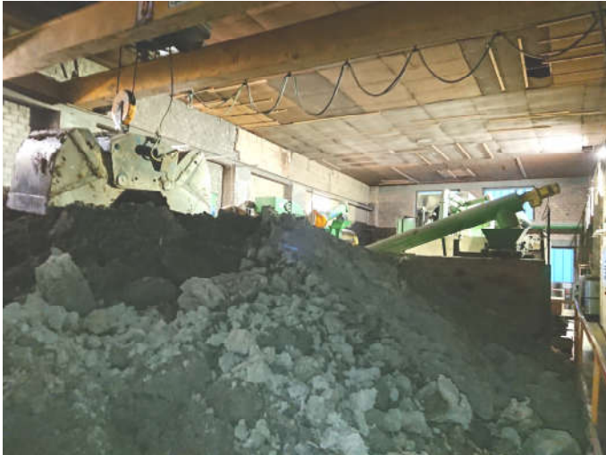
Abbildung 2: Kran an Decke im Rohstofflager
