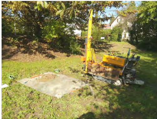
Abb.5: Rammkernsondierung am Ansatzpunkt RKS 1/13
