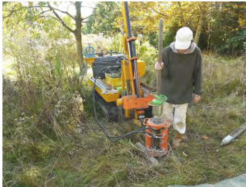
Abb.7: Rammkernsondierung am Ansatzpunkt RKS 2/13
