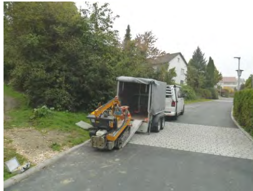
Abb.3: Anlieferung des Raupensondierfahrzeuges
