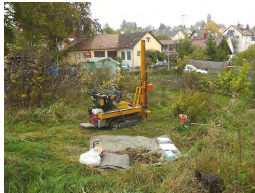
Abb.9: Rammkernsondierung am Ansatzpunkt RKS 4/13
