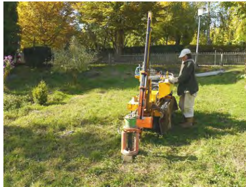
Abb.13: Rammkernsondierung am Ansatzpunkt RKS 6/13
