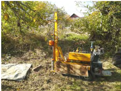
Abb.8: Rammkernsondierung am Ansatzpunkt RKS 3/13
