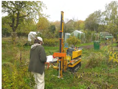
Abb.10: Schwere Rammsondierung am Ansatzpunkt DPH 3/13
