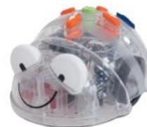
Der BlueBot verfügt über verschiedene Richtungstasten. Die Schüler\*innen können damit eine Abfolge von Bewegungen speichern. Diese einfache Planung der Bewegungsabläufe entspricht bereits der algorithmischen Logik des Programmierens. Die BlueBots bieten einen einfachen Zugang zu den Themen Robotik, Programmieren und digitaler Technik.
